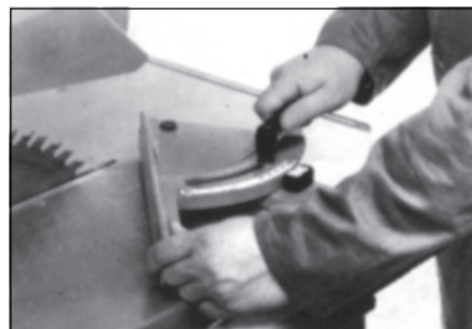
B Winkelanschlag hochklappen und auf die gewünschte Gradzahl einstellen.
